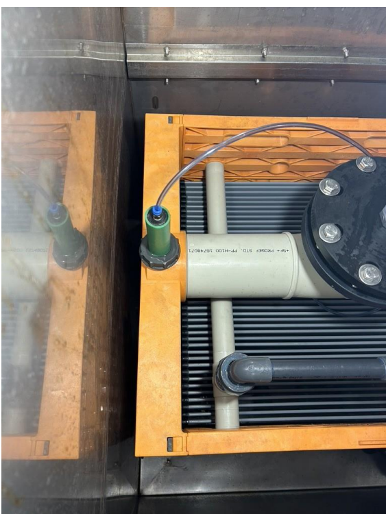
Silicon carbide membrane module inside Clera.One
